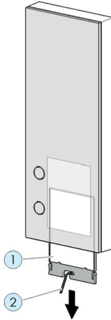
1. Ziehen Sie die Schublade **(1)** mit Hilfe des beiliegenden Innensechskantschlüssels **(2)** nach unten heraus.
