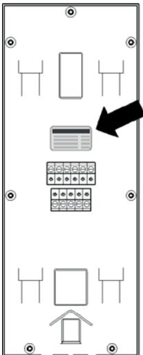
Auf dem Typenschild befinden sich die Seriennummer, Produktkennzeichnungen und Informationen zu Gerätetyp.
